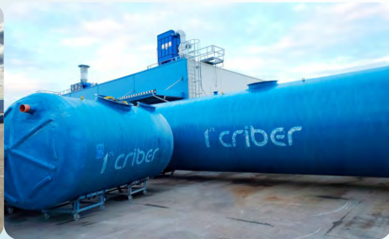
Rezervor supraterran apă potabilă 15 / 100 mc
