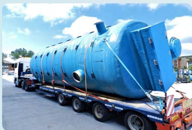
Stație de pompare Ø=3 m h=7.5 m
